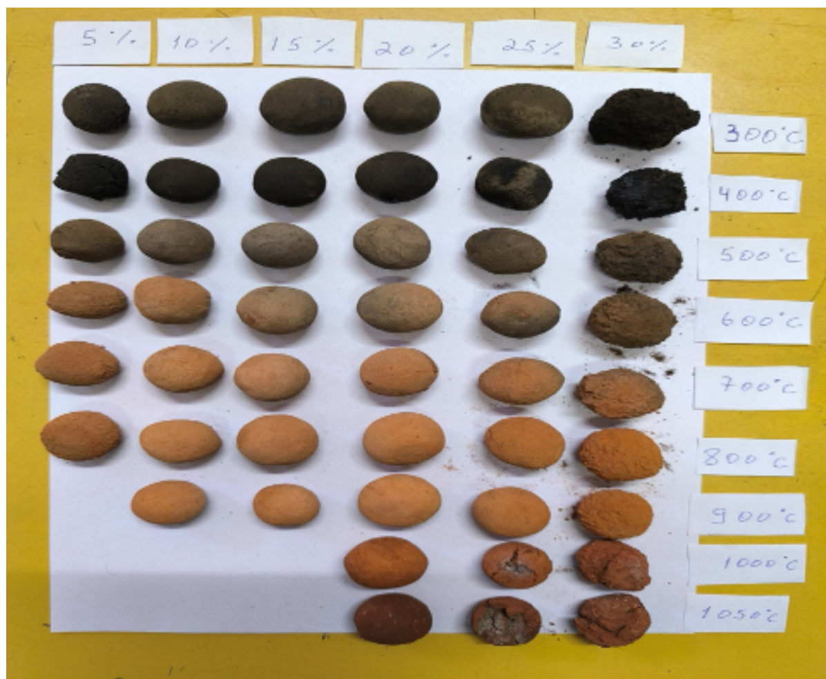
Рисунок 1. Внешний вид смеси нефтешлама и бентонита после нагревания
